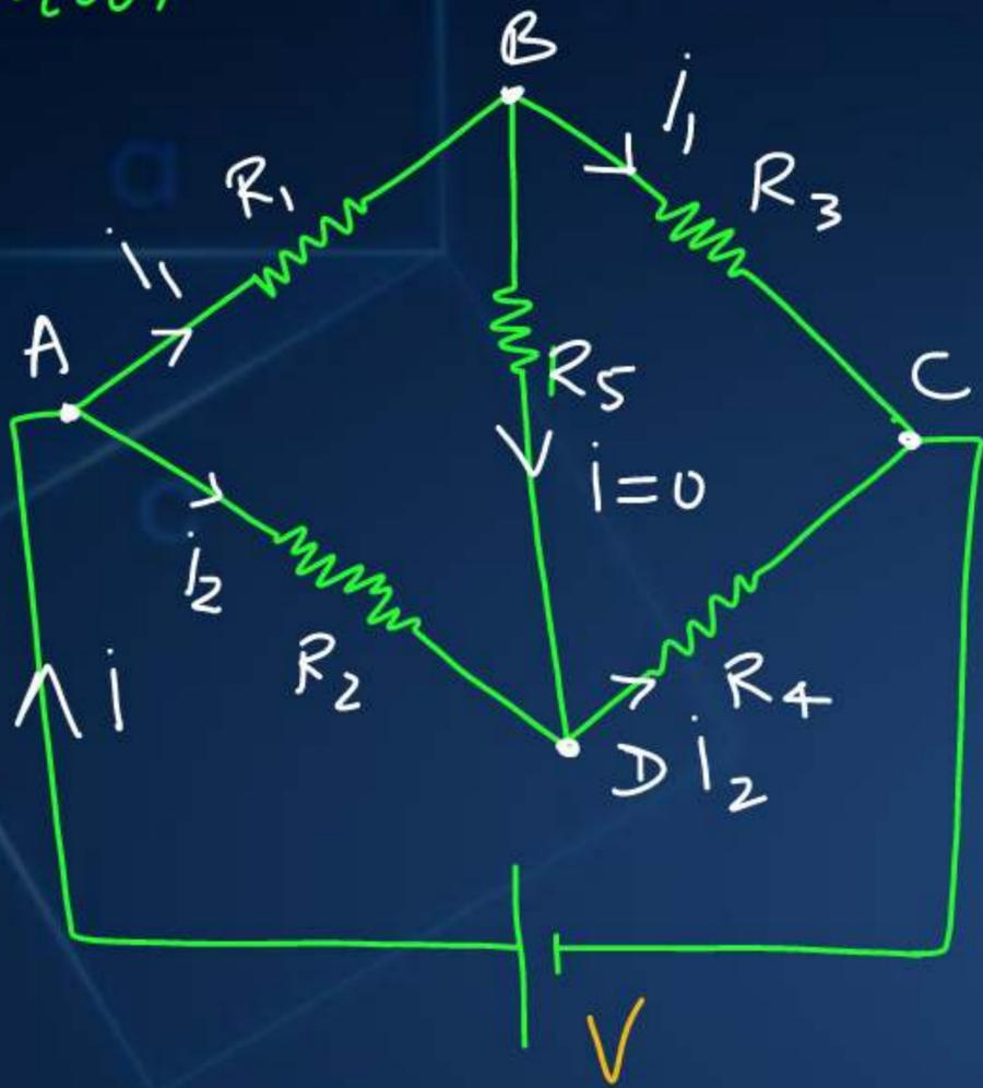
$$V_A - V_B = i_1 R_1 \quad \text{--- (i)}$$
